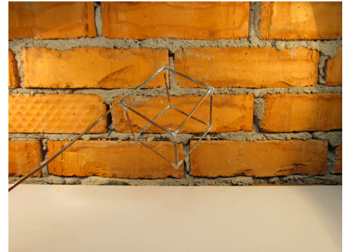
Рис. 1: Кубический каркас для наблюдения явлений, связанных с поверхностным натяжением
