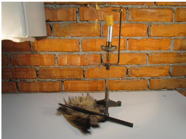
Рис. 1: Свеча вблизи острия и электрофорная машина
