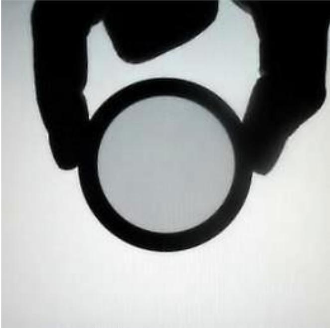
Если пропустить частично поляризованный свет через поляризатор, то при вращении прибора вокруг направления луча интенсивность прошедшего света будет изменяться от  $I_{\max}$  до  $I_{\min}$ , причем переход от одного из этих значений к другому будет совершаться при повороте поляризатора на угол, равный  $\pi/2$ . То есть за один полный оборот по два раза будут достигаться максимальные и минимальные значения.
