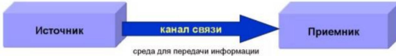
Канал связи – физическая среда распространения сигнала. В т.ч. электрические сигналы: переменный электрический ток, переменное магнитное и электрическое поле. Это гармонические колебания!
