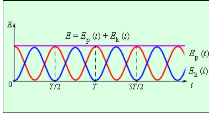
$$E_{\text{мех}} = E_{\text{к}} + E_{\text{п}} = \frac{mv^2}{2} + \frac{kx^2}{2}$$
