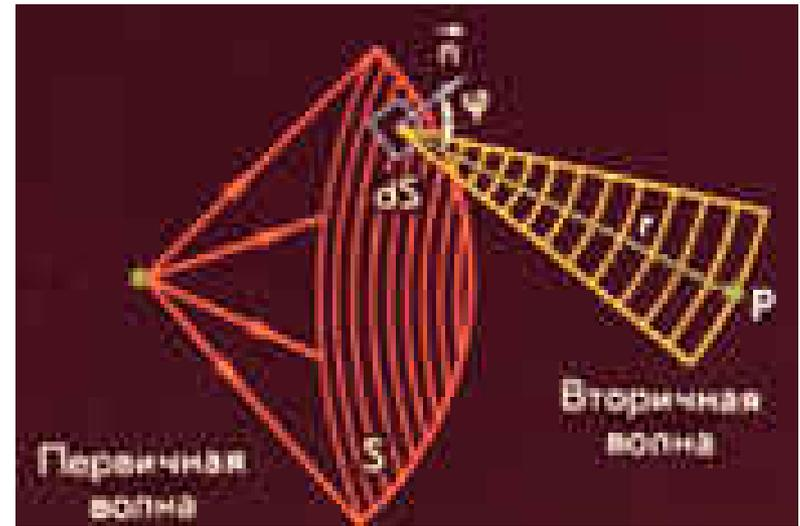
Согласно принципу Гюйгенса-Френеля каждый элемент волнового фронта служит источником вторичной сферической волны, амплитуда которой пропорциональна площади элемента  $dS$ , и обратно пропорциональна расстоянию  $r$  до точки наблюдения  $P$
