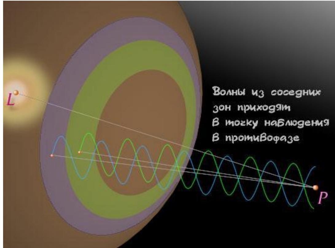
Это означает, что и результирующие колебания, создаваемые каждой из зон в целом, будут для соседних зон различаться на  $\pi$ . Следовательно, колебания в точке наблюдения от соседних зон ослабляют друг друга.
