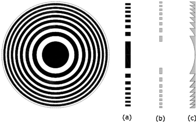
Если поставить на пути световой волны пластинку, которая перекрывала бы все нечетные (a) или четные (b) зоны, то интенсивность света резко вырастет. Такая пластинка, называемая зонной, действует как собирающая линза.
