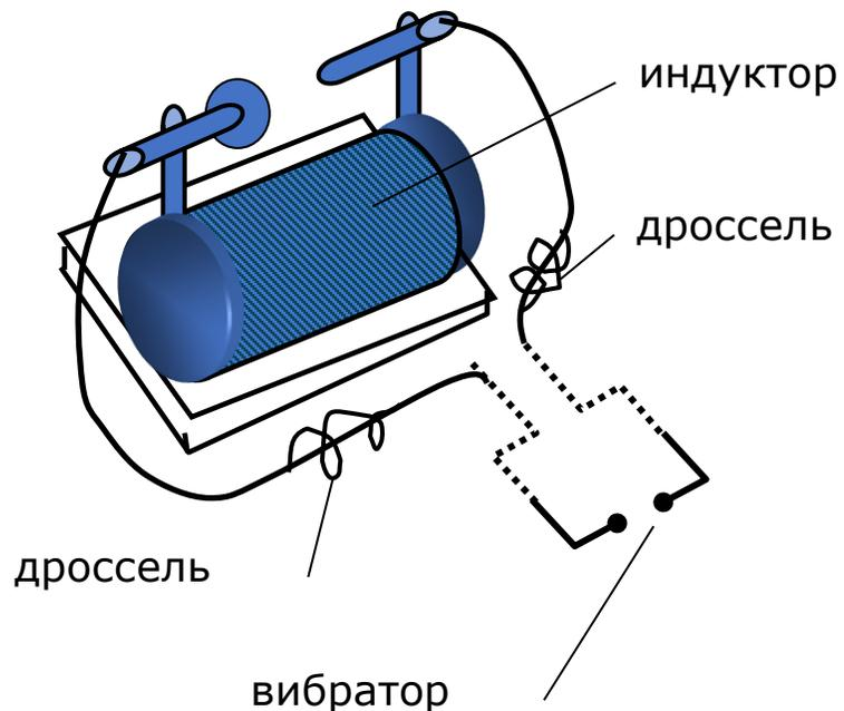
Вибратор состоял из двух медных стержней с шариками-наконечниками, разделенных искровым промежутком. Питание вибратора осуществлялось от индукционной машины (индуктора), на обкладках конденсатора которой создавалось высокое напряжение. Напряжение прикладывалось через дроссели к вибратору (последние нужны для «отсечки» высокочастотных колебаний (тока) в обмотку индуктора).
