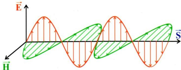
В векторном виде  $\vec{S} = [\vec{E} \times \vec{H}]$ ,  $[S] = 1 \frac{Вт}{м^2}$ .
