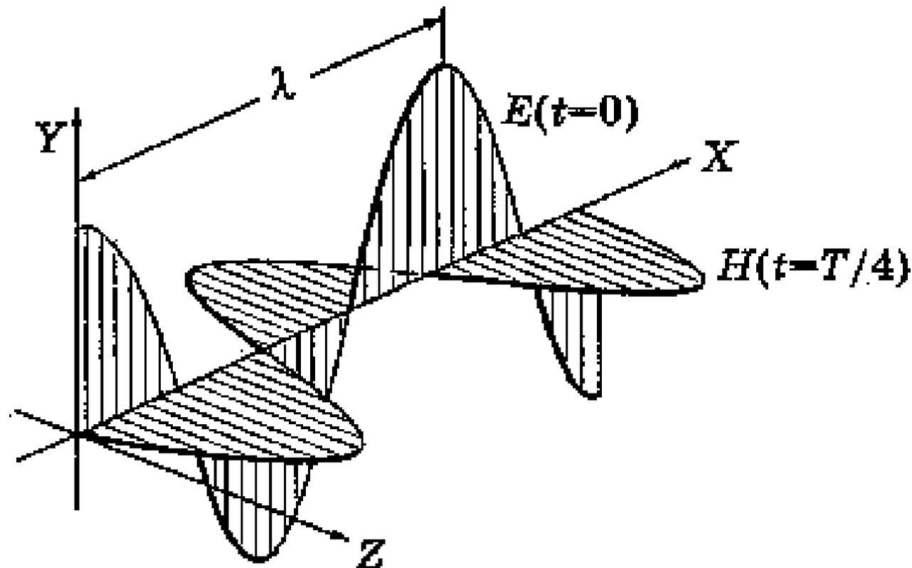
В процессе колебаний электрическое поле постепенно переходит в магнитное, магнитное — в электрическое и т.
