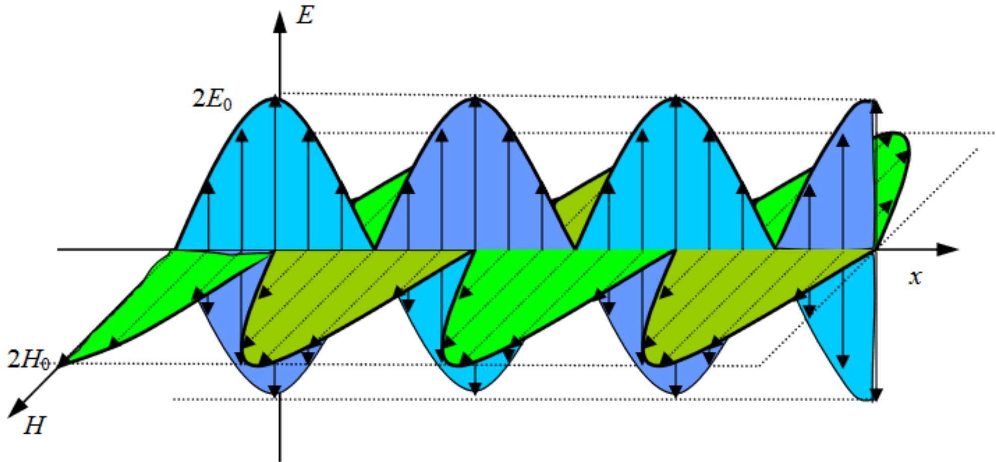
В процессе колебаний электрическое поле постепенно переходит в магнитное, магнитное - в электрическое и т. д.
