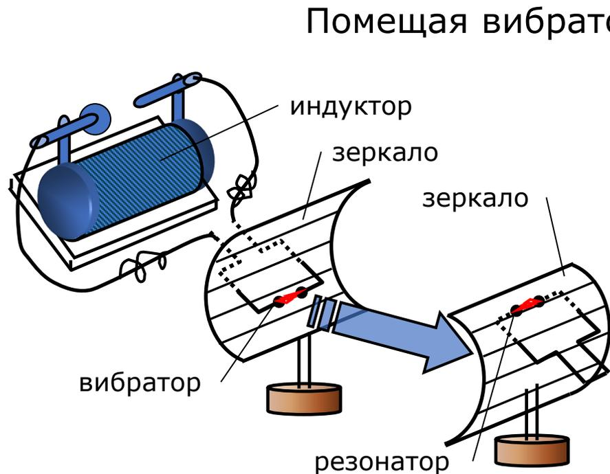
Помещая вибратор в фокусе параболического металлического зеркала, Герц получал направленные плоские э/м волны с  $\lambda = 0,5 \dots 10$  м. Другое такое же зеркало устанавливалось напротив первого. В его фокусе находилось устройство, подобное вибратору, **резонатор** – контур с замкнутыми на себя внешними концами. При настройке резонатора на наилучший прием волн в нем также проскакивала искра
