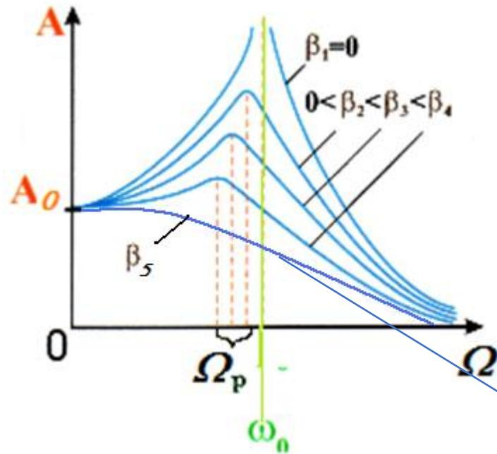
Т.о. с ростом коэффициента затухания уменьшается рост амплитуды при резонансе, а резонансная частота смещается влево по оси частот.
