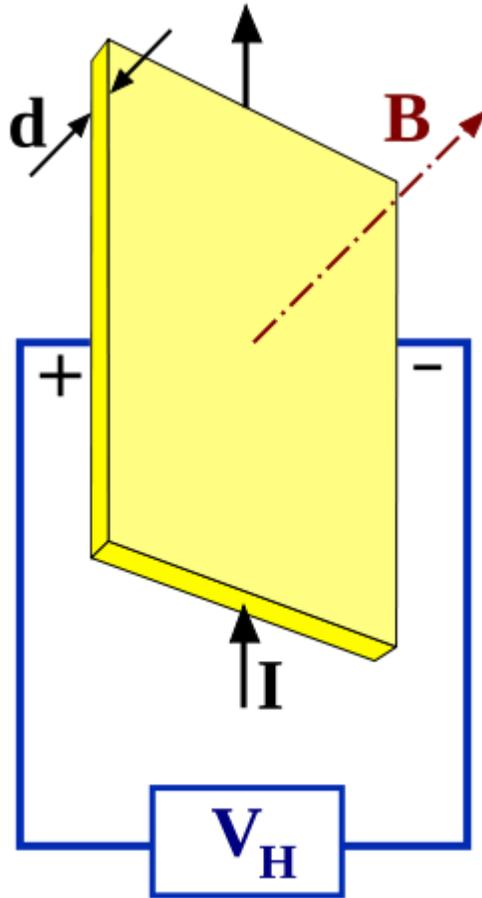
измерение коэффициента Холла  $R$  позволяет определить характер проводимости (электронный - постоянная Холла имеет отрицательное значение или дырочный - постоянная Холла имеет положительное значение), а также концентрацию носителей тока  $n$ .
