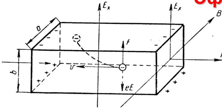
Магнитное поле действует также и на те электроны внутри проводников, упорядоченное движение которых образует ток.
