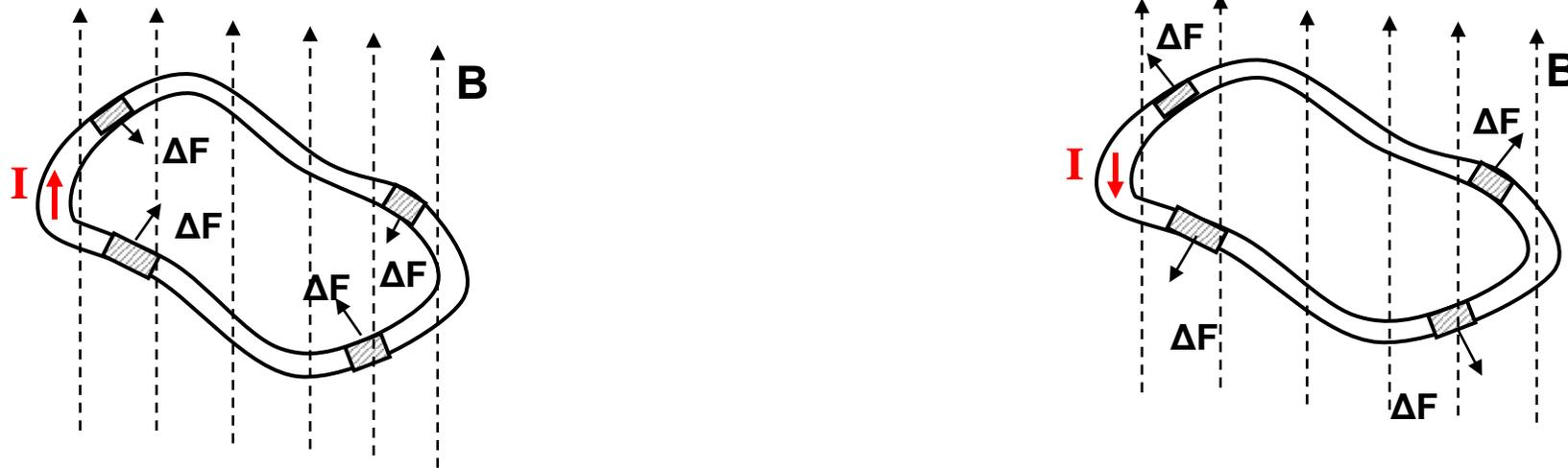
В случае если магнитное поле однородно, то силы только деформируют контур (в зависимости от направления тока), а равнодействующая этих сил равна нулю.
